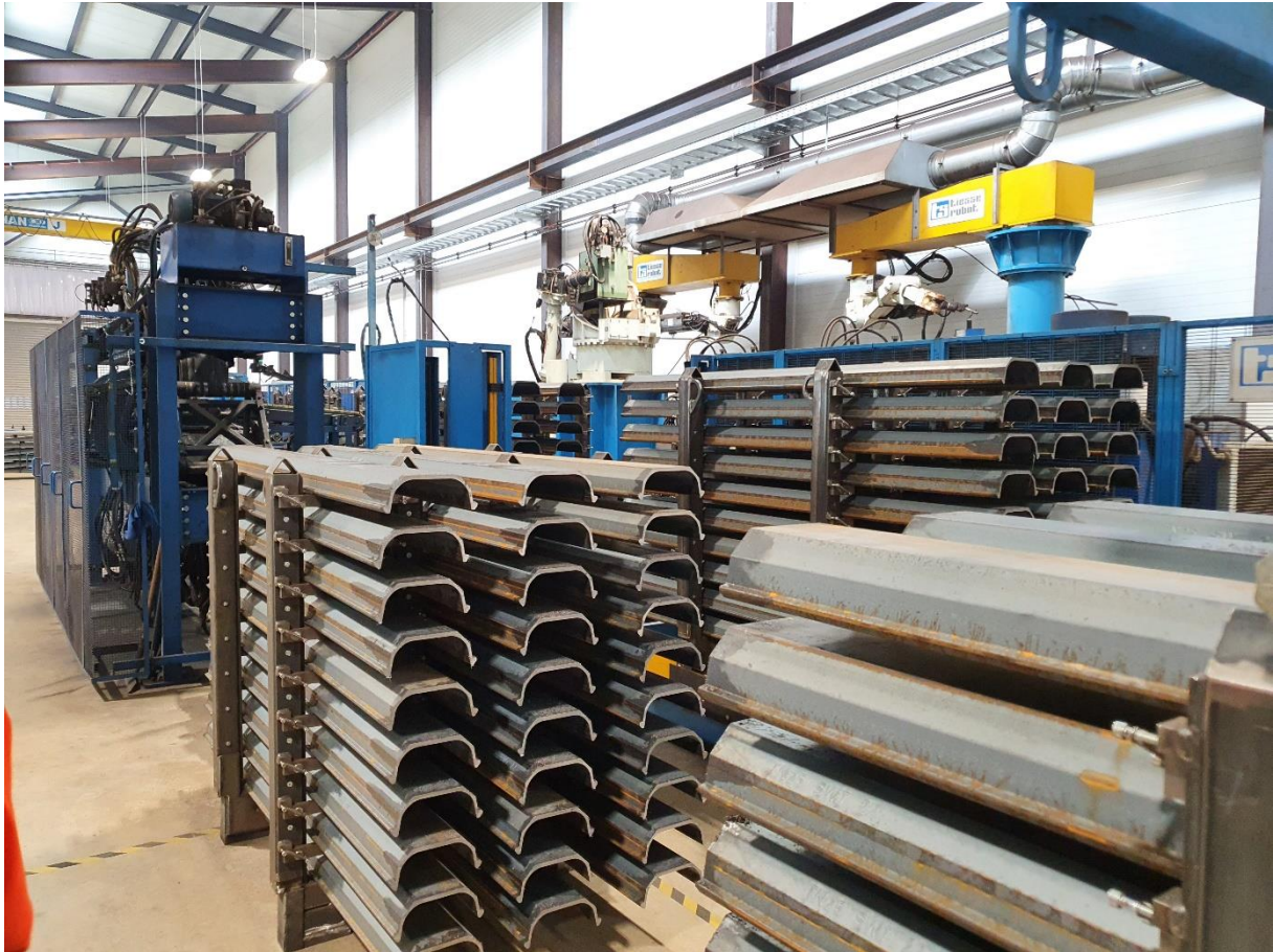
Figure 1 (Di Stasi Cirillo Daniella SBB CFF FFS) Fabrication des traverses métalliques en auge
